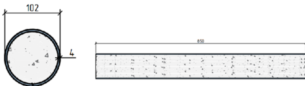
Рис. 1. Геометрические параметры образца армированной трубобетонной колонны
