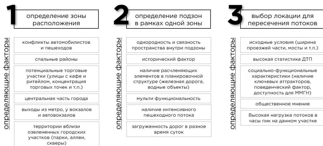
Рис. 1. Алгоритм поиска оптимального расположения точек пересечения транспортно-пешеходных потоков
