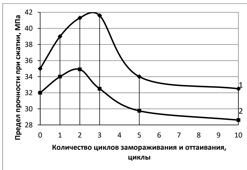
Рис. 2. Влияние попеременного замораживания и оттаивания мелкозернистого бетона в период его твердения в воде (через 14 сут.) на прочность при сжатии: 1 – состав 1:3 и В/Ц = 0,45; 2 – то же с В/Ц = 0,5
