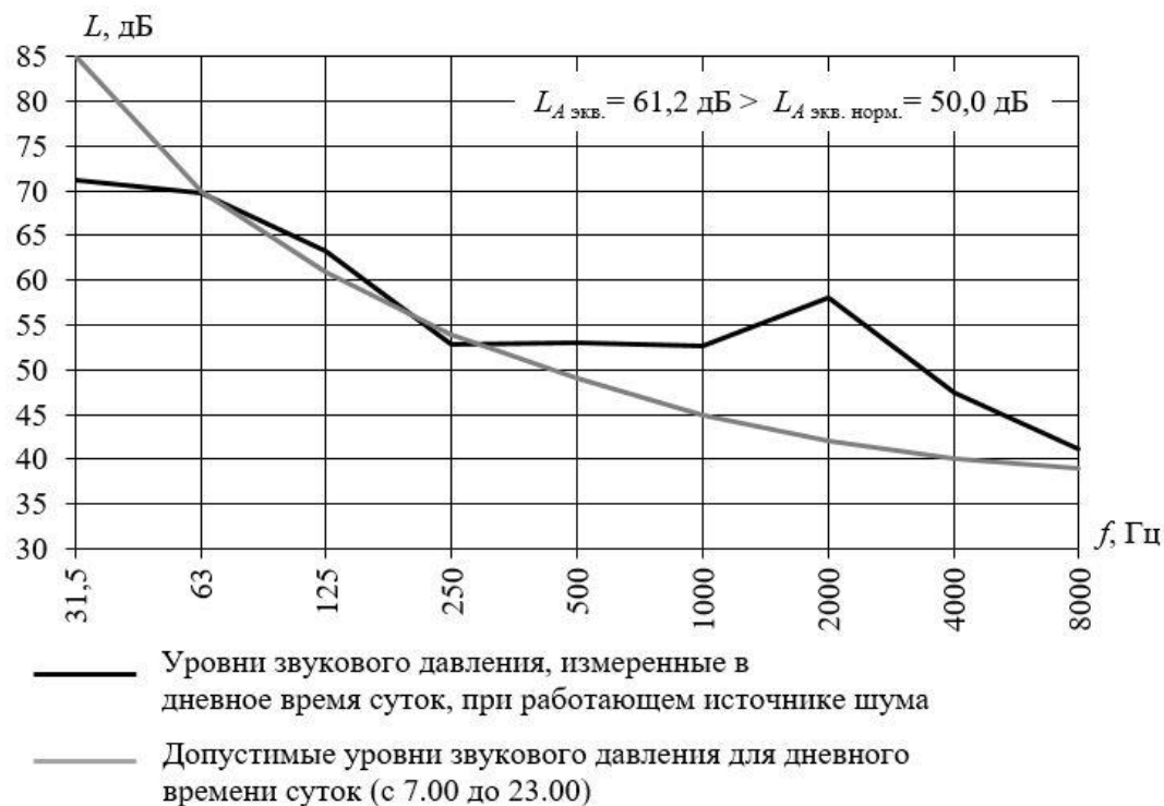
Рис. 1. Сравнение УЗД, измеренных в дневное время суток на территории жилой застройки, с допустимыми значениями по СП [5]
