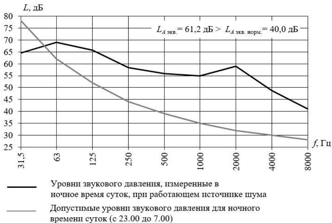
Рис. 2. Сравнение УЗД, измеренных в ночное время суток на территории жилой застройки, с допустимыми значениями по СП [5]
