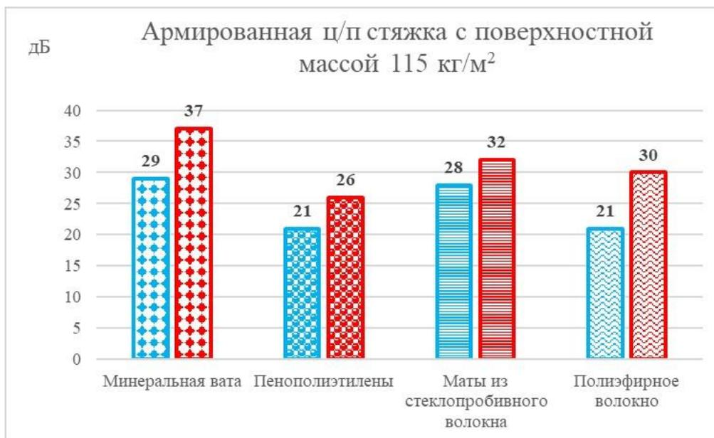
Рис. 4. Минимальные и максимальные значения индекса улучшения изоляции ударного шума  $\Delta L_{\gamma}$ , с применением стяжки толщиной 60 мм
