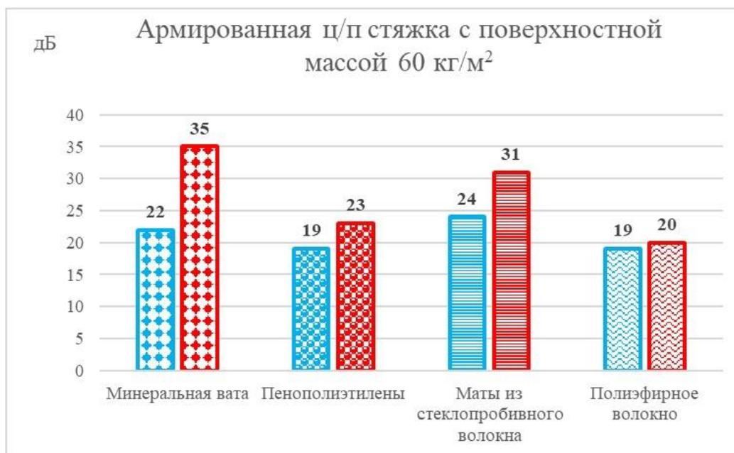
Рис. 3. Минимальные и максимальные значения индекса улучшения изоляции ударного шума  $\Delta L_v$  с применением стяжки толщиной 35 мм
