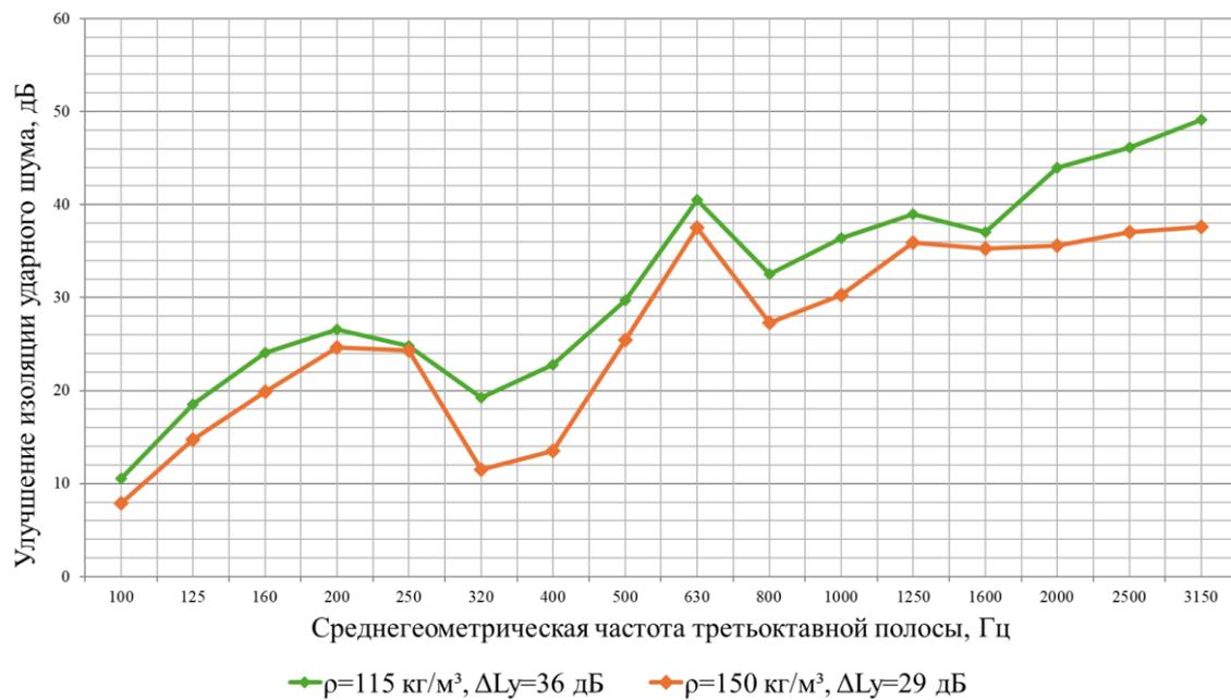
Рис. 7. Частотные характеристики улучшения изоляции ударного шума плитами из каменной ваты толщиной 25 мм разных плотностей при стяжке  $\rho = 227 \text{ кг/м}^2$
