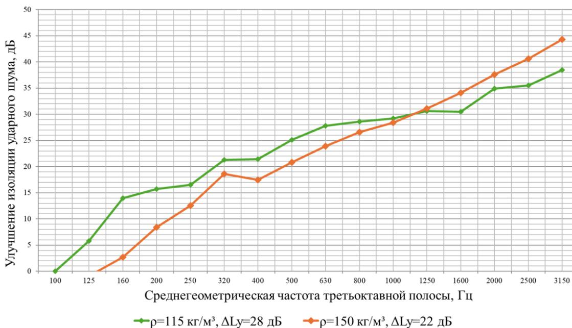
Рис. 5. Частотные характеристики улучшения изоляции ударного шума плитами из каменной ваты толщиной 25 мм разных плотностей при стяжке  $\rho = 60 \text{ кг/м}^2$
