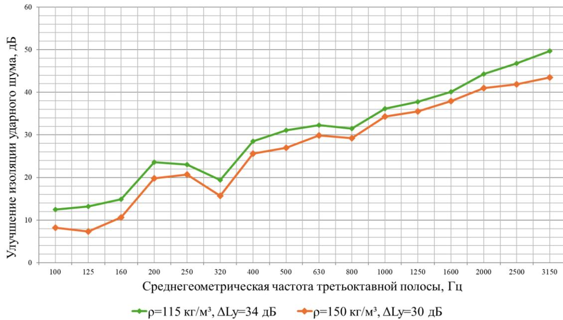
Рис. 6. Частотные характеристики улучшения изоляции ударного шума плитами из каменной ваты толщиной 25 мм разных плотностей при стяжке  $\rho = 115 \text{ кг/м}^2$
