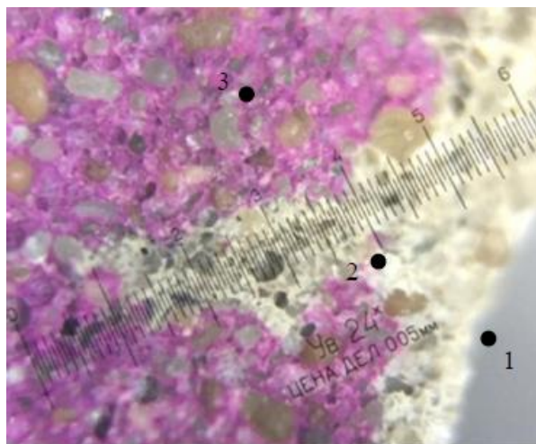
Рис. 7. Точки, принятые для исследования микроструктуры цементного камня в зоне карбонизации образца: 1 – на поверхности образца, в зоне карбонизации; 2 – на границе зоны карбонизации; 3 – в зоне, не тронутой карбонизацией. Фотография авторов с увеличением в 24 раза
