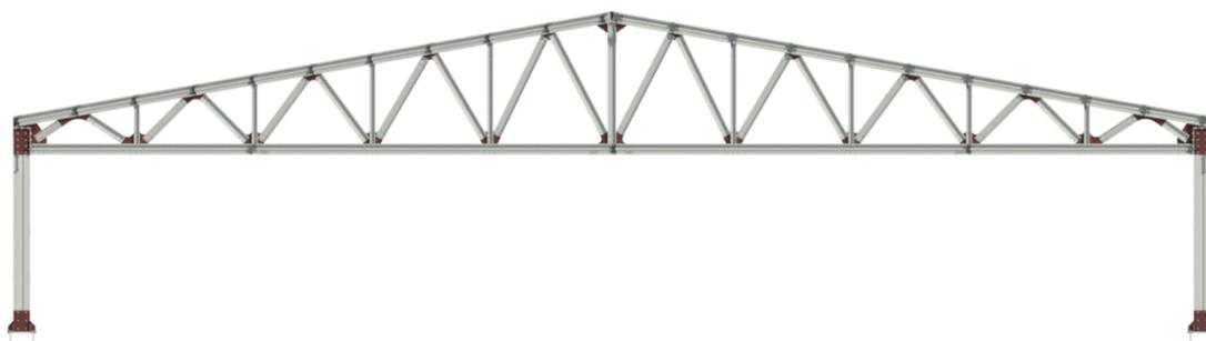
Рис. 2. Конструктивная схема рамного здания с фермой
