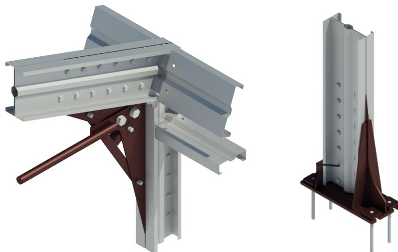
Рис. 4. Соединение элементов каркаса рамных зданий: карнизный узел (слева), база
