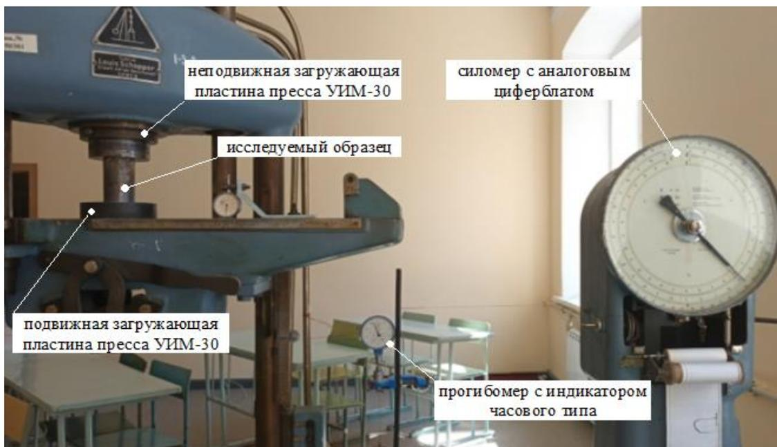
Рис. 2. Экспериментальная установка для испытаний лабораторных образцов осевой сжимающей нагрузкой при помощи универсальной испытательной машины УИМ-30
