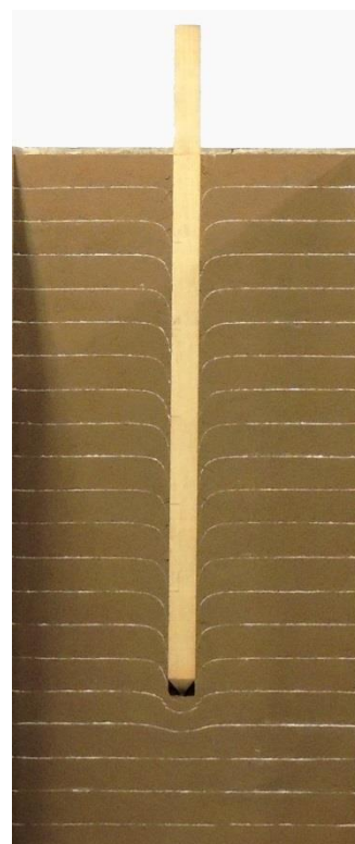
Рис. 12. Деформация несущей области околосвайного грунта шириной 3d
