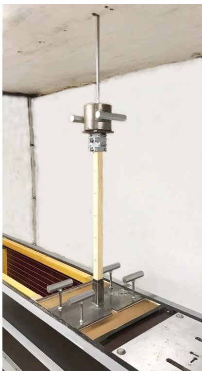
Рис. 5. Погружение сваи с инвентарным наголовником в грунтовой массив с помощью молота весом 8 кг
