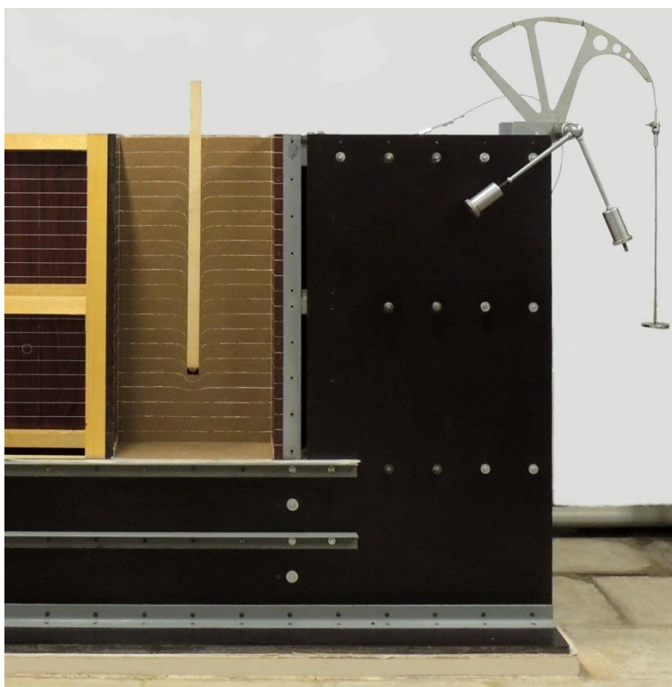
Рис. 11. Массив из лессового суглинка с деформированной областью околосвайного грунта после испытаний вертикальными нагрузками
