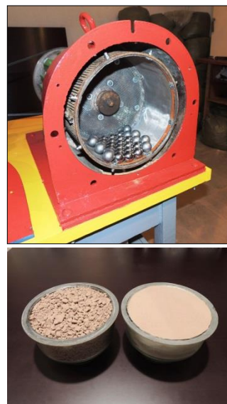
Рис. 2. Шаровая мельница. Лессовый суглинок до и после помола
