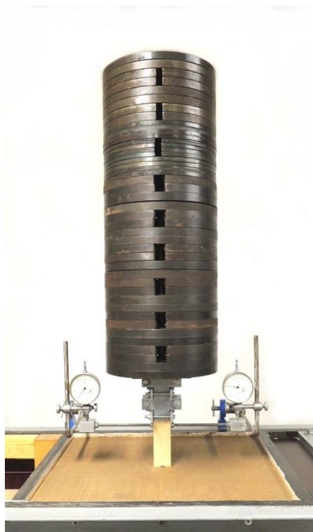
Рис. 6. Испытание модели сваи вертикальной вдавливающей нагрузкой
