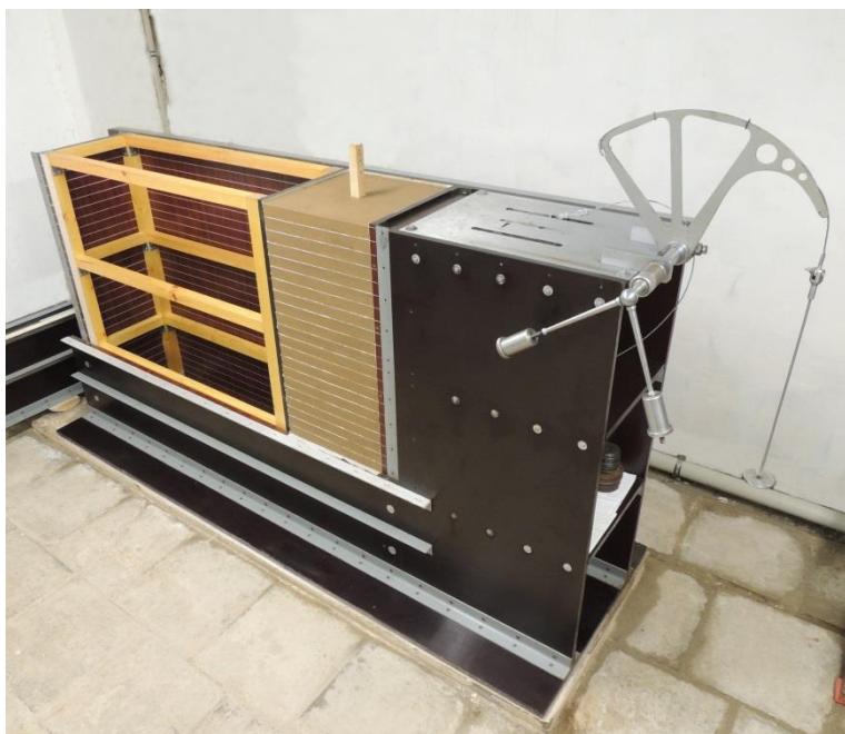
Рис. 9. Массив из лессового суглинка с погруженной в него моделью сваи после снятия лицевой стенки лотка
