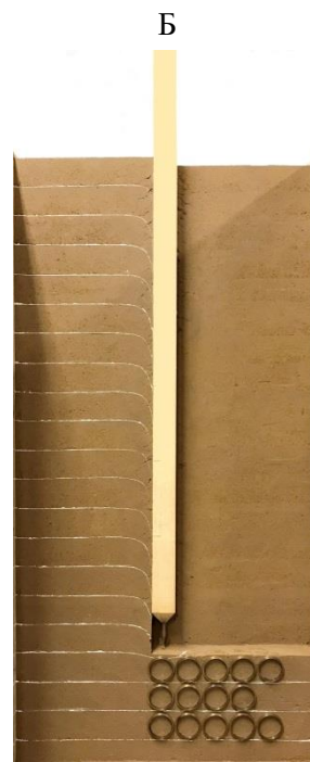
Рис. 14. Отбор образцов околосвайного грунта: А – у боковой поверхности модели сваи; Б – под острием модели сваи
