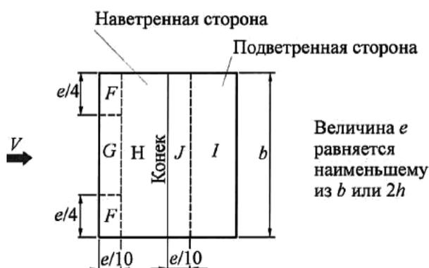
Рис. 3. Схема ветровых нагрузок для двускатных покрытий при направлении ветра, перпендикулярном коньку
