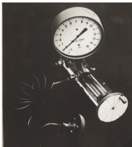
Рис. 14. Устройство для тарировки гидравлических колец и манометров гидроаэростатического типа
