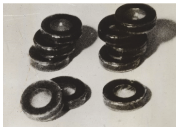
Рис. 7. Цилиндрические элементы для заполнения внутренней полости трубчатых образцов
