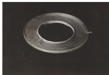
Рис. 10. Бескамерное жесткое кольцо с проточкой по наружному диаметру, с винтом для крепления стальной струны и с отверстием для иглы манометра – измерителя давления в поровой воде
