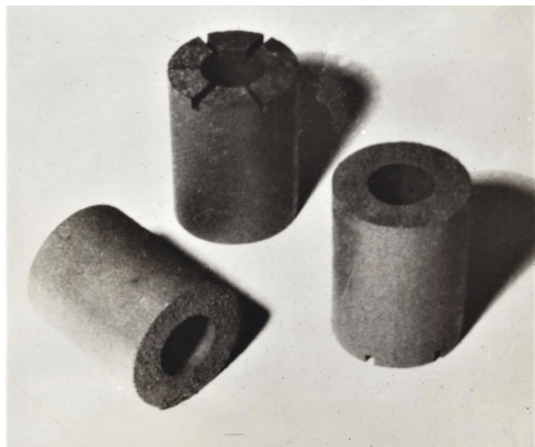
Рис. 6. Трубчатые образцы глинистого грунта, подготовленные для испытаний на сдвиг в режиме кручения
