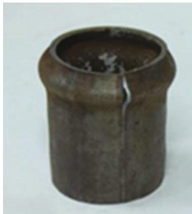
Рис. 6. Образец трубы после испытания
