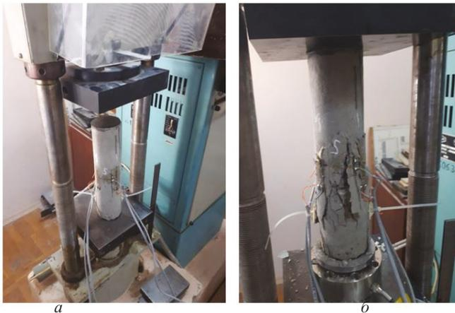
Рис. 3. Установка для тензометрических испытаний бетона: а – бетонный образец до испытаний; б – разрушенный бетонный образец после испытаний
