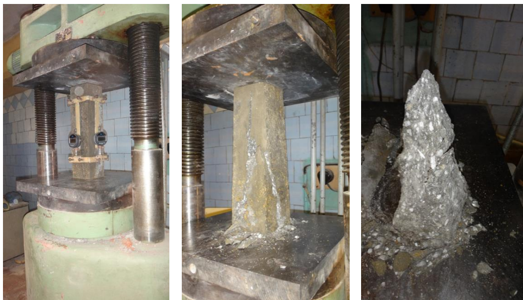
Рис. 1. Испытание образцов призм с целью определения призмной прочности и модуля упругости бетона на сжатие
