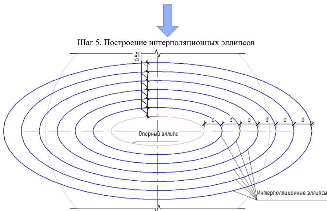
Рис. 1 (окончание). Алгоритм геометрического построения изополей аэродинамических характеристик
