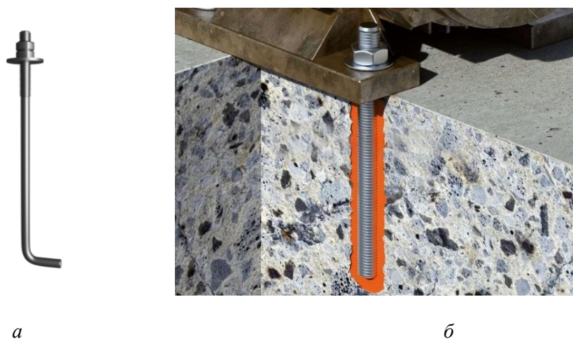
Рис. 1. Анкеры: а – фундаментный болт типа 1, б – химический анкер
