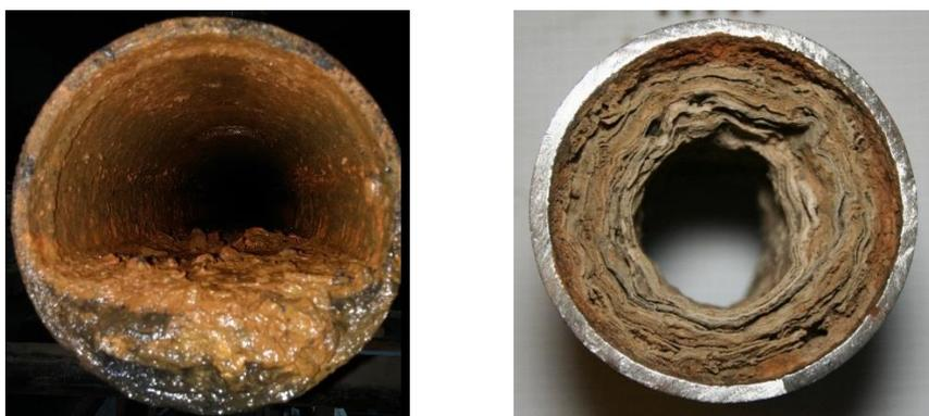
Рис. 1. Примеры отложений в трубах теплообменников
