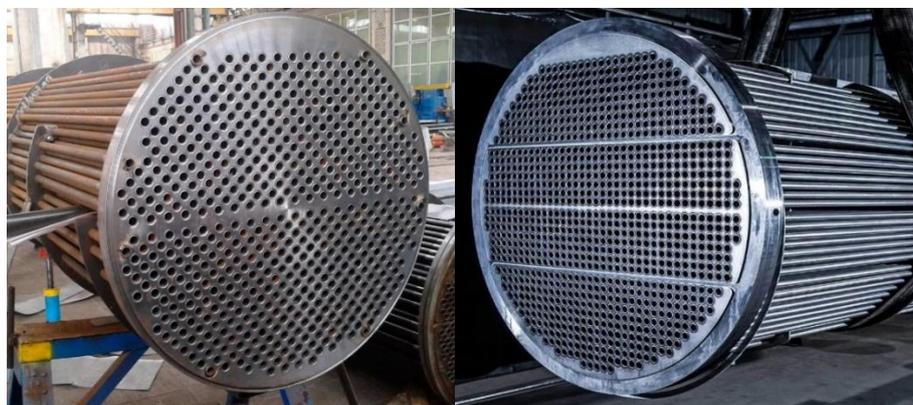
Рис. 4. Шахматное и коридорное расположение трубок в теплообменнике
