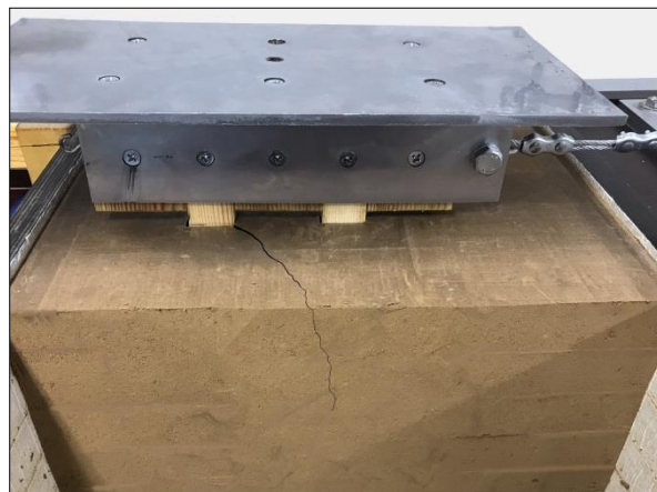
Рис. 3. Трещина в массиве грунта при горизонтальном перемещении группы из 2 свай \Delta_r=5 мм
