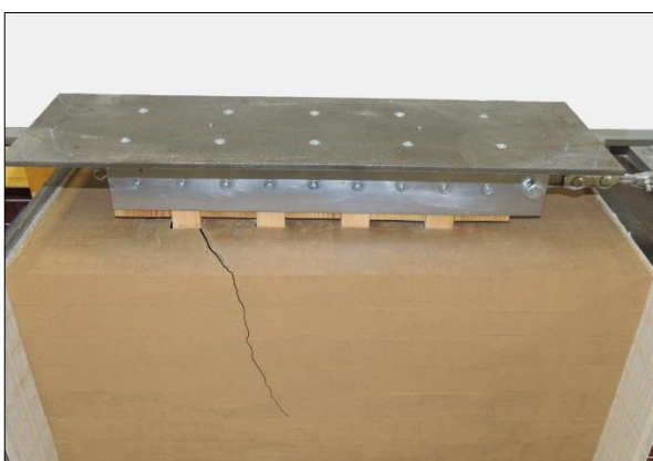
Рис. 4. Трещина в массиве грунта при горизонтальном перемещении диафрагмы из 4 свай \Delta_r=5 мм и работы 2 последних свай на выдергивание
