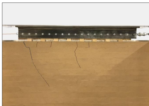
Рис. 7. Трещины в глубине массива грунта при горизонтальном перемещении диафрагмы из 8 свай \Delta_r=4 мм и работы 5 последних свай на выдергивание
