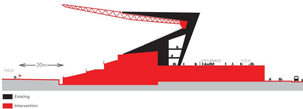
Рис. 4. Сечение трибун до и после реорганизации
