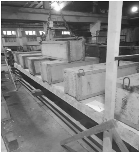
Рис. 3. Плита ПК63.15-8 во время испытания
