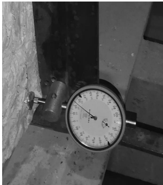
Рис. 4. Установка индикатора (цена деления 0.001 мм) для измерения взаимного сдвига продольной стержневой предварительно напряженной арматуры
