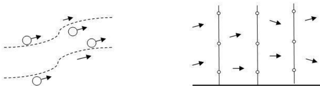
Рис. 1. Слева: измерительные приборы двигаются вместе с частицами среды; справа: параметры среды измеряют приборы, закрепленные в фиксированном положении
