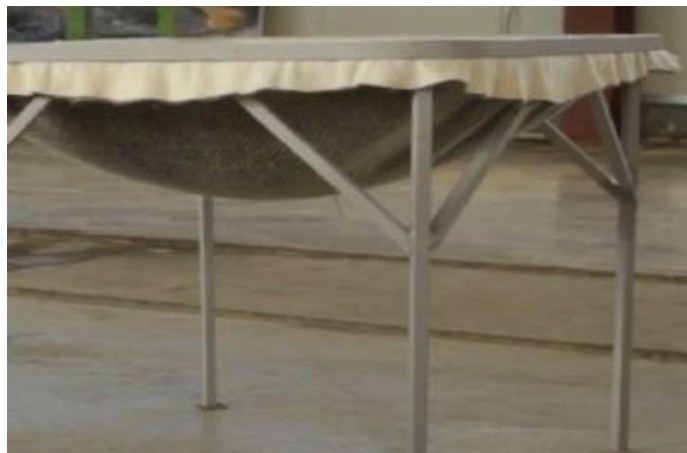
Рис. 1. Заполненное водой бентонитовое полотно на металлическом каркасе
