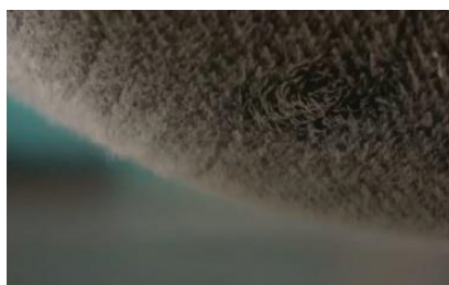
Рис. 3. Место образованного спицей отверстия после самовосстановления полотна
