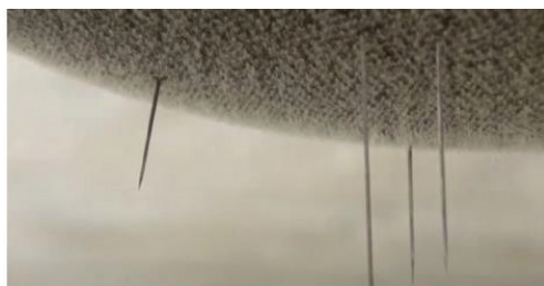
Рис. 2. Пропущенные спицы сквозь дно заполненной водой емкости и бентонитового полотна
