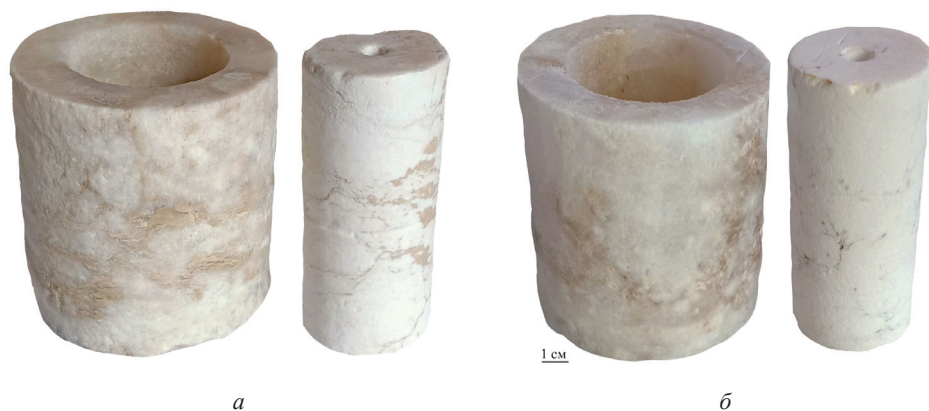
Рис. 1. Общий вид керна (слева) и испытуемого образца (справа) гипсовой породы: а – № 5.2; б – № 6.2
