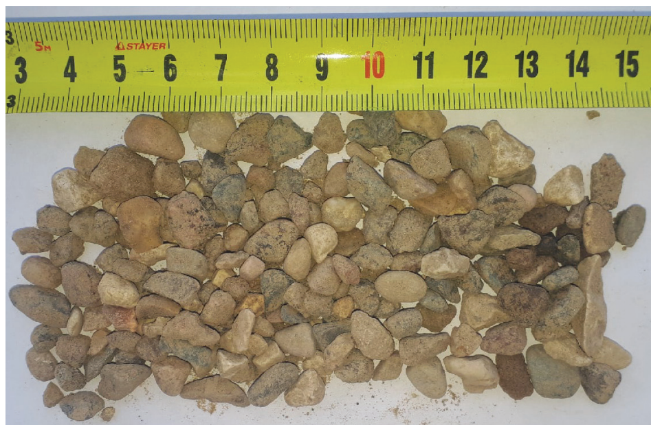
Рис. 2. Гранулометрический состав мелкозернистого гравия, используемого для изготовления бетонной смеси
