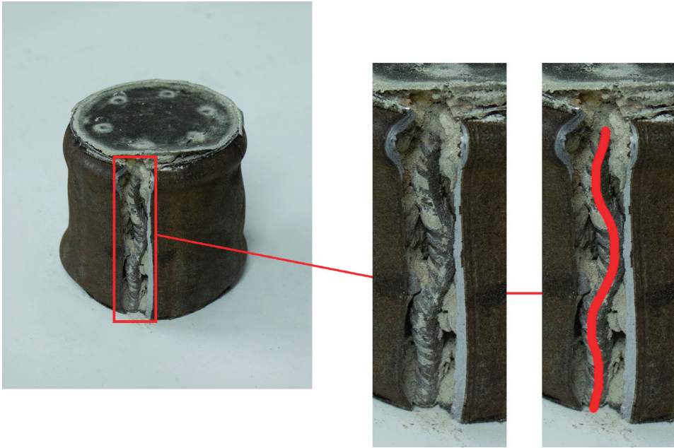
Рис. 7. Форма потери устойчивости арматуры в трубобетонном образце
