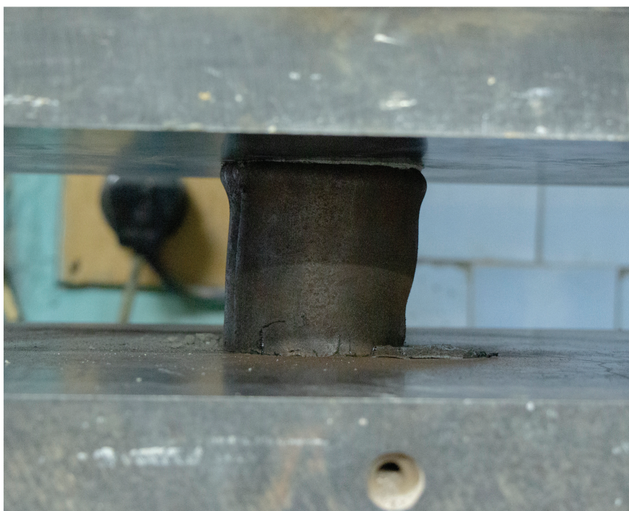
Рис. 5. Пластический характер разрушения трубобетонного образца
