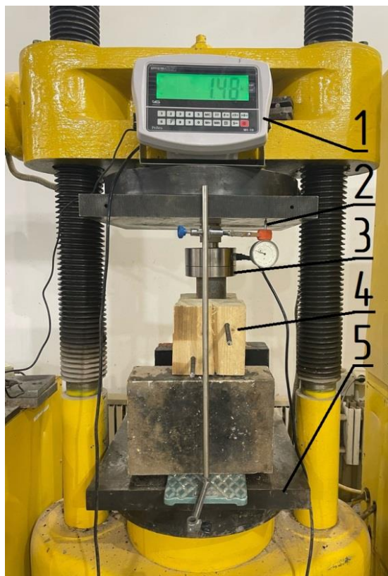
Рис. 2. Оборудование для проведения испытания нагельной системы (иллюстрация авторов): 1 – электронный информационный блок динамометра ДЭП/6-2Д-100С-1; 2 – индикатор перемещений; 3 – тензодатчик динамометра ДЭП/6-2Д-100С-1; 4 – испытываемый образец; 5 – гидравлический пресс П-125
