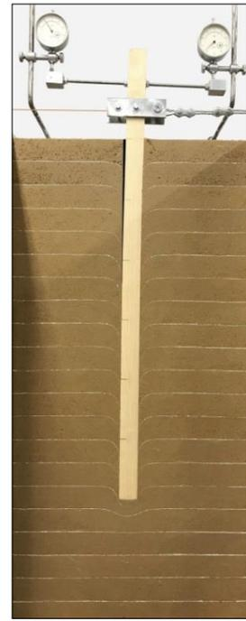
Рис. 6. Деформация несущей области околосвайного грунта. Отрыв тыльной части боковой поверхности сваи от грунта
