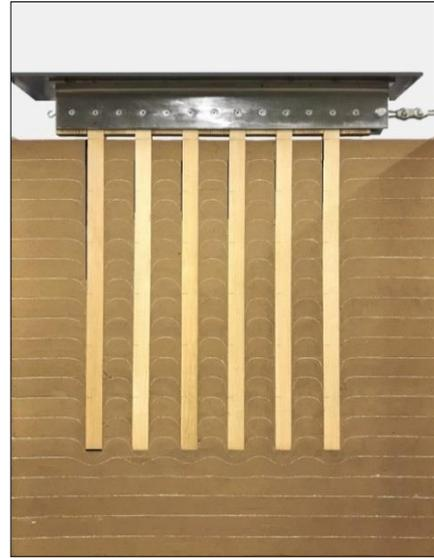
Рис. 10. Диафрагма из 6 свай с деформированной после испытаний областью околосвайного грунта и с отрывом тыльной части боковой поверхности свай от грунтового массива
