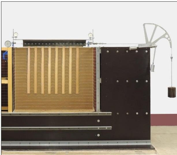
Рис. 11. Диафрагма из 8 свай в массиве из лессового суглинка с деформированной после испытаний областью околосвайного грунта
