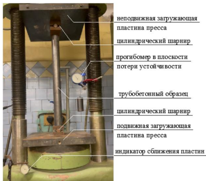
Рис. 1. Экспериментальная установка для испытаний трубобетонных колонн длиной 700 мм осевой сжимающей нагрузкой на устойчивость
