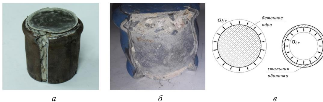
Рис. 2. Образцы трубобетонных конструкций после испытания на продольное деформирование: а – с хрупким разрушением оболочки, б – с пластическим деформированием ободки, в – схема распределения радиальных напряжений, где \sigma_{b,r} ( \sigma_{t,r} ) – радиальное напряжение в бетоне (трубе), вызванное стальной оболочкой (бетонным сердечником)
