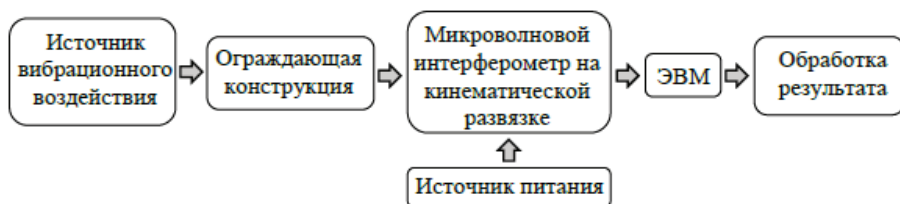
Рис. 1. Структурная схема определения виброперемещений ограждающих конструкций
