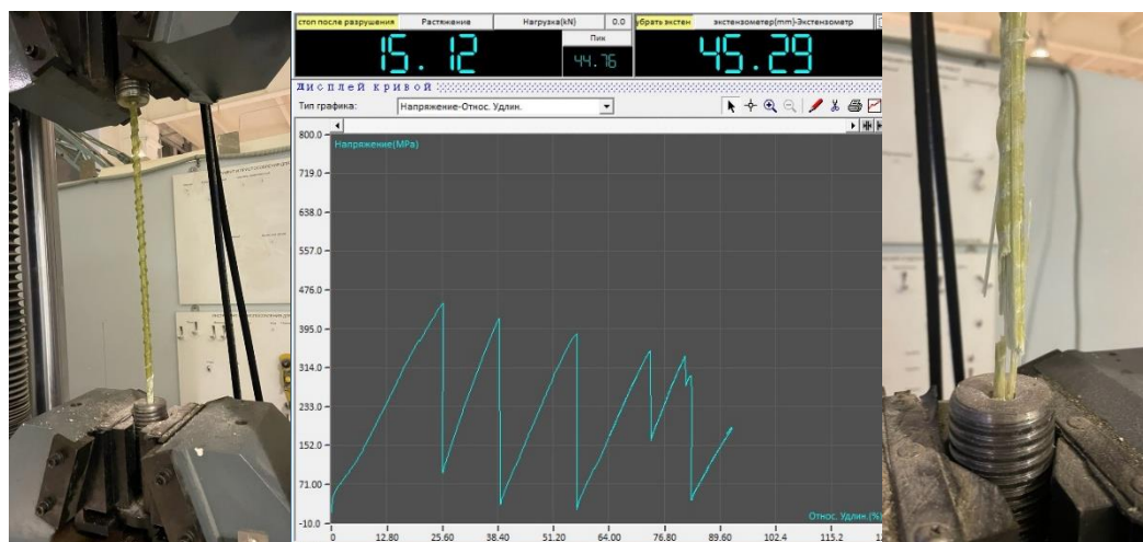
Рис. 3. Испытания АКП на осевое растяжение: диаграмма «напряжение – удлинение» и характер разрушения
