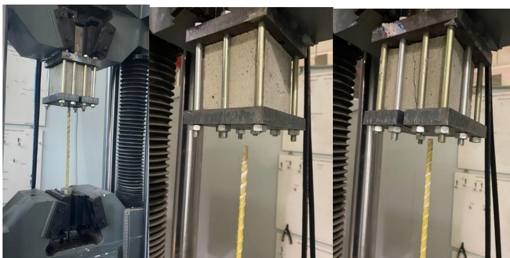
Рис. 1. Испытательная машина и характер разрушения
