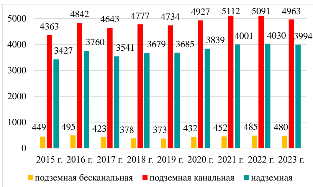
Рис. 6. Протяженность магистральных тепловых сетей по способам прокладки, тыс. км
