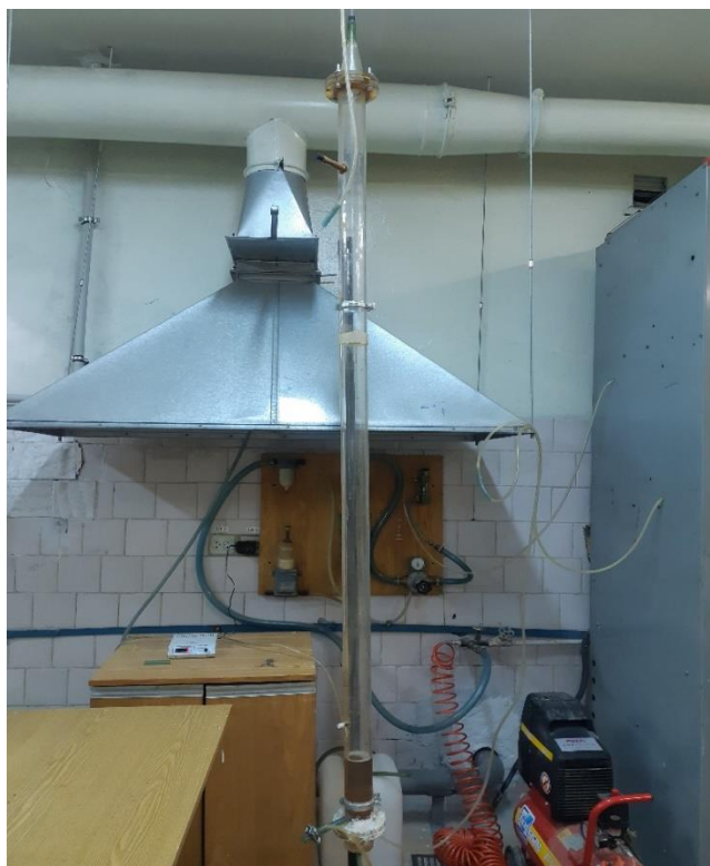
Рис. 2. Исходный объем сточной воды (0,5 л) в контактной колонне перед процессом озонирования
