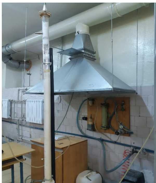
Рис. 3. Увеличенный объем сточной воды в контактной колонне в процессе режима озонирования. Интенсивное пенообразование
