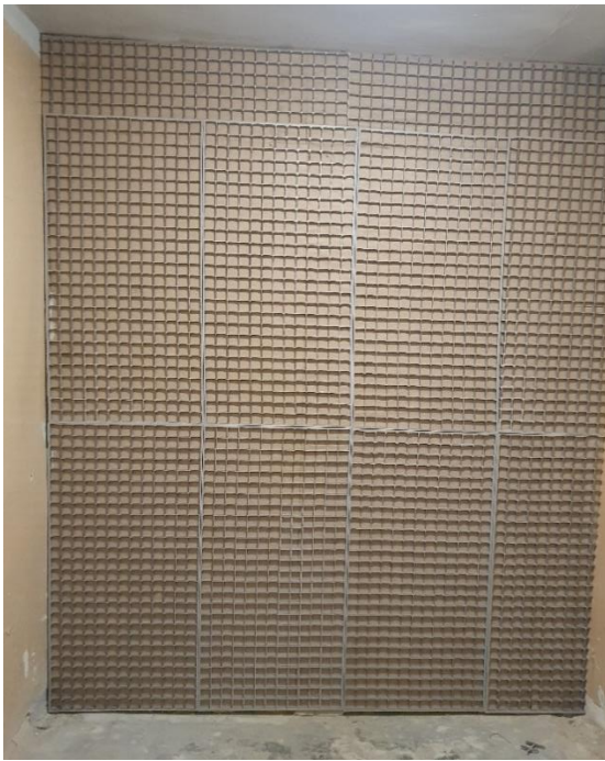
Рис. 3. Лицевая поверхность исследуемого образца с формообразующими решетками
