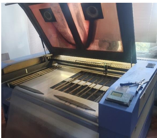
Рис. 1. Изготовление формообразующих решеток из пластиковых панелей: а – станок лазерной резки; б – готовые изделия
