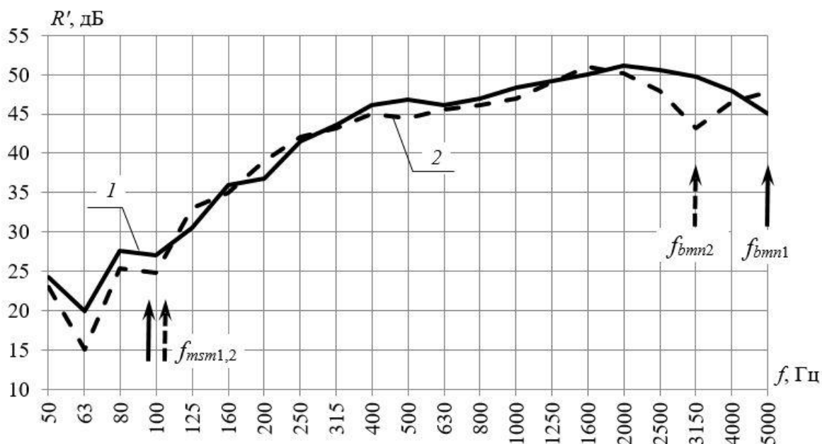
Рис. 2. Результаты натуральных экспериментальных исследований звукоизоляции легких бескаркасных перегородок (размеры образцов 2,65 \times 2,2 \text{ м} ): 1 – образец № 1, перегородка с фрагментированными торкрет-облицовками и акустическим разобщением слоев ( \mu_1 = 53,2 \text{ кг/м}^2 ; h_1 = 108 \text{ мм} ); 2 – образец № 2, перегородка из сэндвич-панели с листовыми облицовками из ГВЛ, с пазогребневым соединением среднего слоя ( \mu_2 = 60,5 \text{ кг/м}^2 ; h_2 = 100 \text{ мм} )
