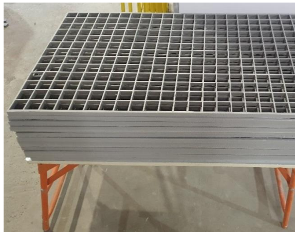
Рис. 1. Изготовление формообразующих решеток из пластиковых панелей: а – станок лазерной резки; б – готовые изделия
