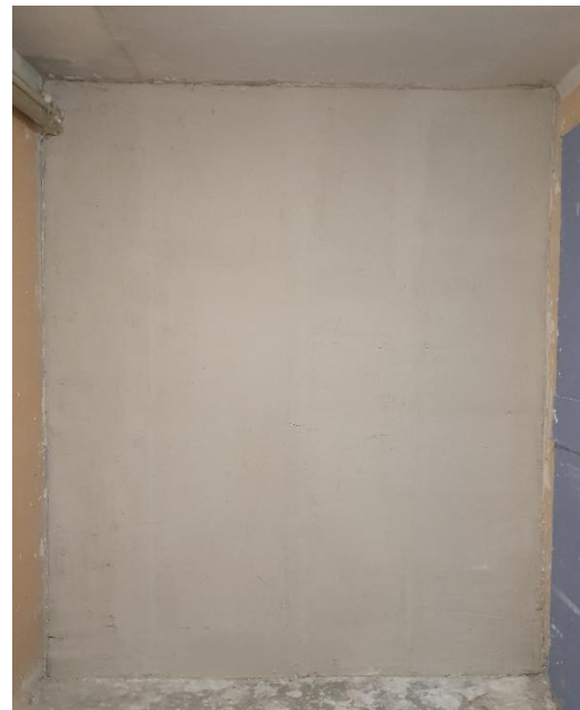
Рис. 6. Лицевая поверхность исследуемой перегородки при проведении измерений звукоизоляции
