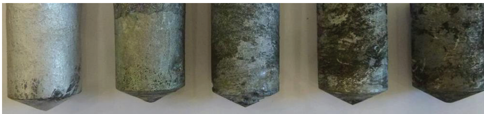
Рис. 1. Отливки ДУКМ системы Al 2 O 3 – Al с ростом процентного содержания керамической фазы (слева направо)
