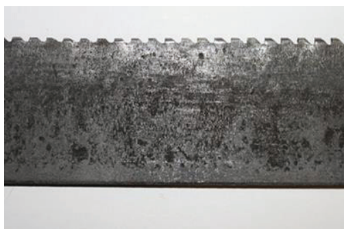
Рис. 6. Износ пилы при резке ТВЭЛ
