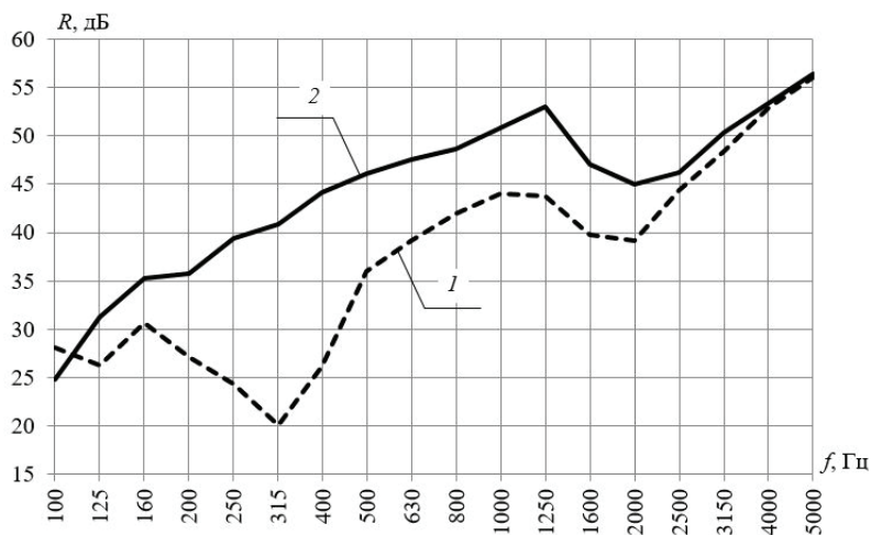
Рис. 4. Экспериментальные частотные характеристики звукоизоляции легких бескаркасных перегородок с торкрет-облицовками (размеры образцов 2,0 \times 1,2 м; торкрет-облицовки из гипсовой смеси h_1 = 24 мм; средний слой из жесткой минеральной ваты, h_2 = 50 мм): 1 – образец без акустического разобщения слоев, общая толщина образца h_{en} = 98 мм; 2 – образец с акустическим разобщением слоев, слои акустического разобщения из матов полиэфирного волокна, h_3 = 4 мм, общая толщина образца h_{en} = 106 мм
