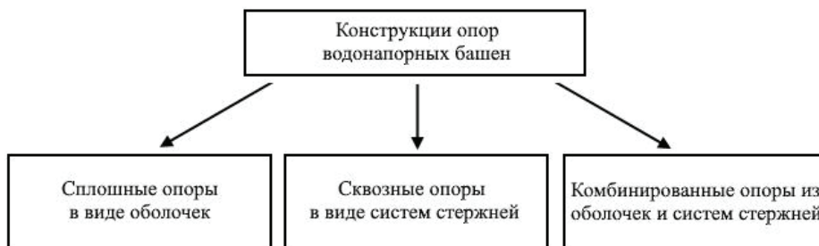
Рис. 2. Виды опор водонапорных башен по конструкции
