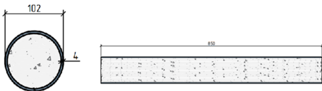
Рис. 2. Геометрические параметры образца неармированной трубобетонной колонны
