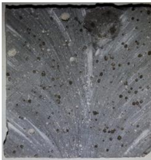
Рис. 2. Срез бетонной призмы, темные пятна – это разорвавшиеся микрокапсулы [3]
