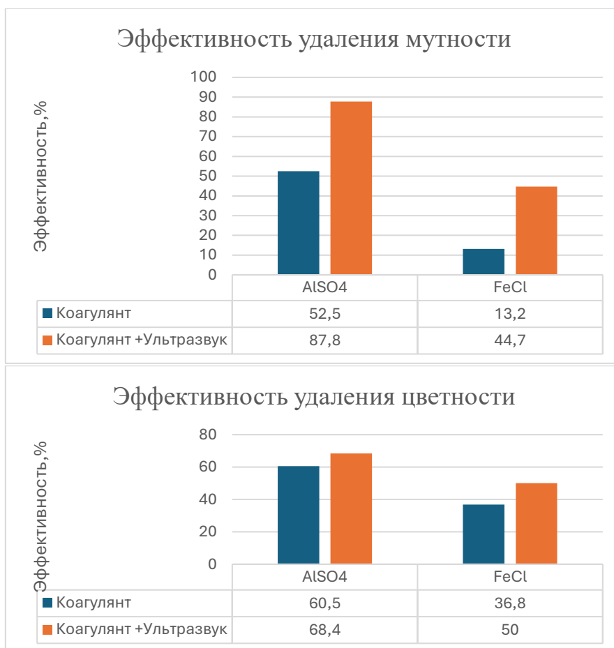
Рис. 1. Эффективность коагуляции с использованием ультразвука
