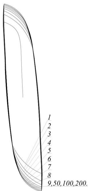
Рис. 2. Стабилизированная петля циклического пластического гистерезиса в зоне жесткого нагружения
