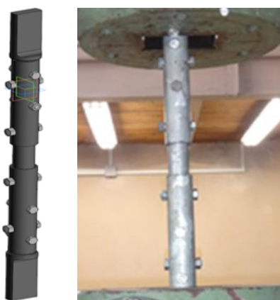
Рис. 8. Общий вид образца болтового соединения наконечника стойки при испытании на растяжение
