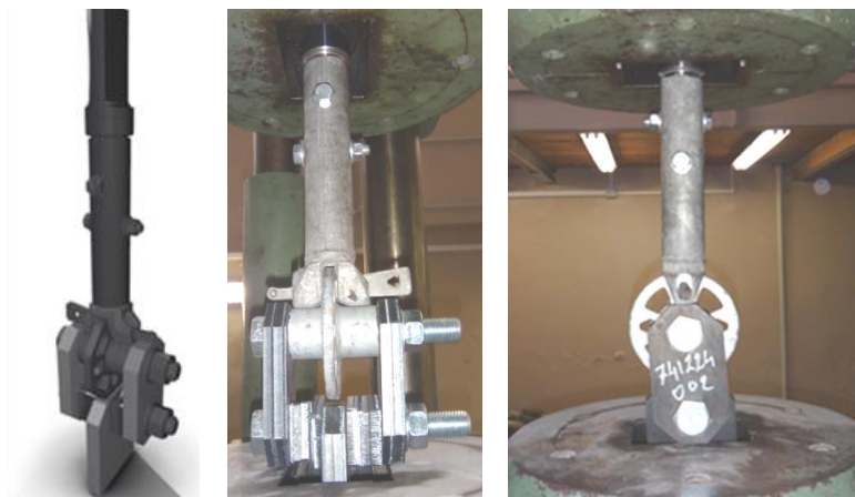
Рис. 1. Общий вид образца узлового соединения ригель-стойка при испытании на растяжение
