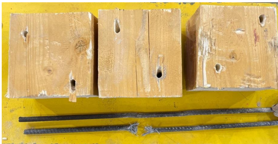
Рис. 4. Форма разрушения экспериментального образца сухого режима (иллюстрация авторов)
