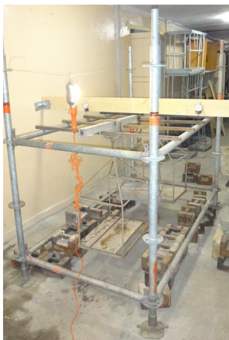
Рис. 2. Общий вид испытания строительных клиновых лесов на действие распределенной нагрузки
