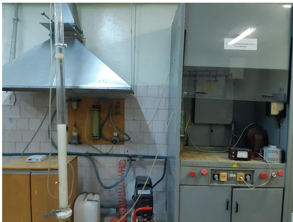
Рис. 1. Лабораторная установка озонирования
