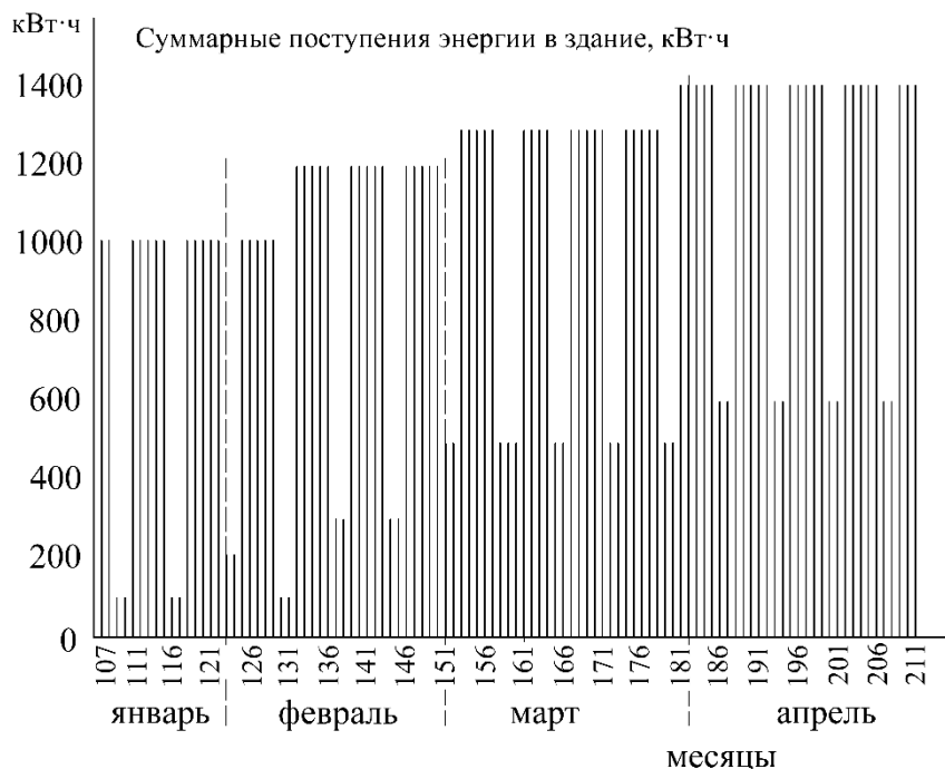
Рис. 3. Диаграмма теплового баланса здания за отопительный сезон: суммарные поступления энергии в здание за период середина января – апрель, кВт·ч
