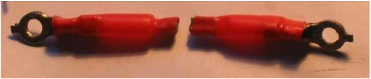
Рис. 5. Термоусадочные зажимы и разрушенный образец после эксперимента
