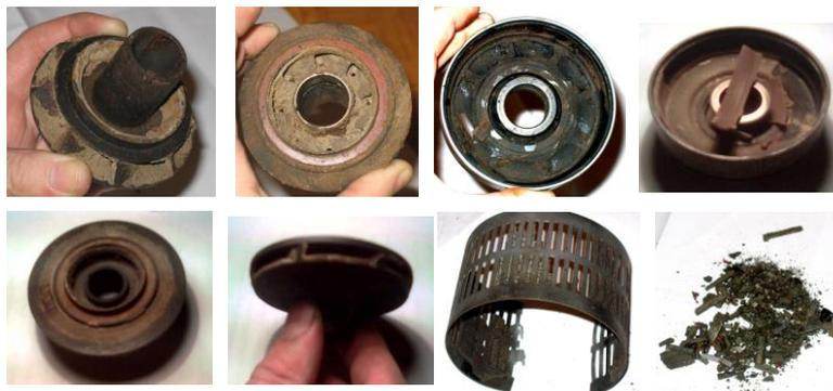
Рис. 1. Крыльчатки, диффузоры и впускная сетка, покрытые солеотложениями: последние два рисунка: сетка забора ЭЦН и отдельные образцы
