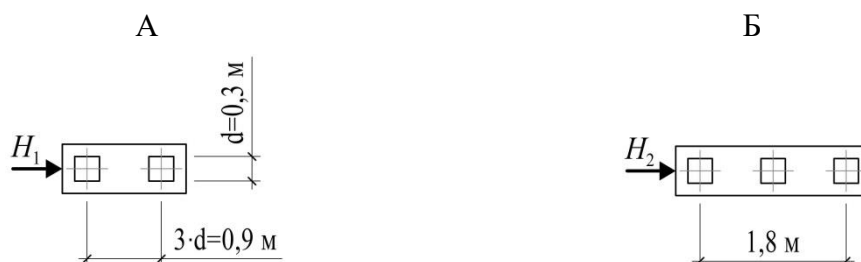
Рис. 1. Схемы горизонтально нагруженных фундаментов: А – ряд из 2 свай; Б – ряд из 3 свай
