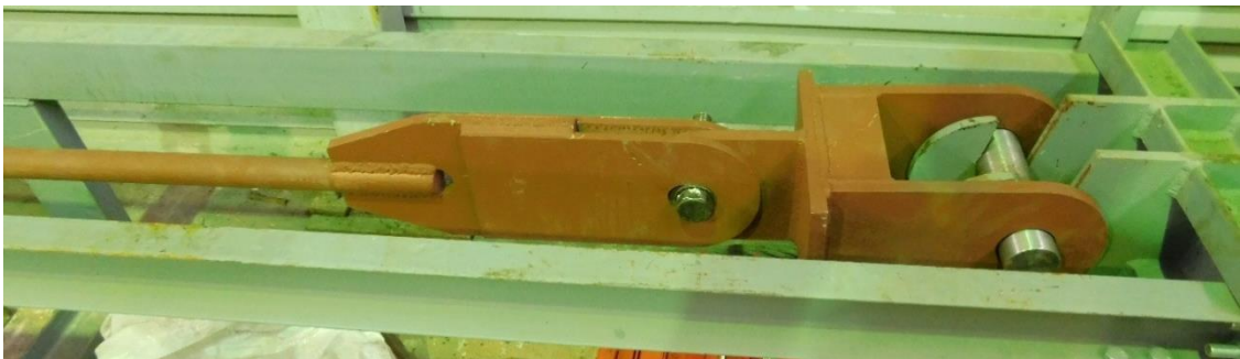
Рис. 4. Жесткое закрепление раскоса на испытательном стенде
